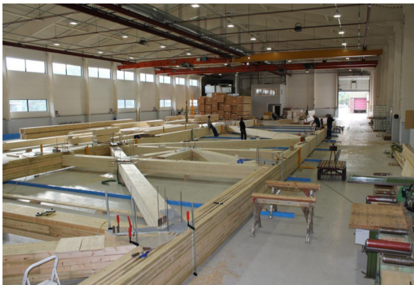
Рис. 4.3. Производство фермы с применением самонарезающих нагелей
