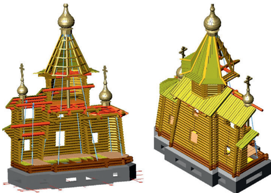
Рис. 5.42. 3-D модель разреза и бокового фасада русской православной церкви в Антарктиде на станции «Беллинсгаузен»
