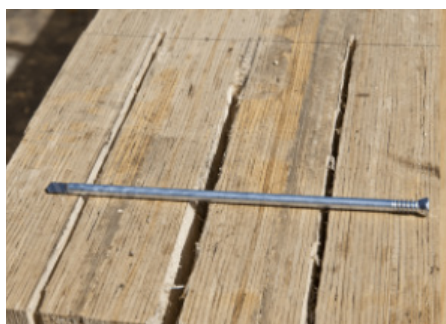
Самонарезающий нагель RothoBlaas и три паза в деревянной конструкции из LVL
