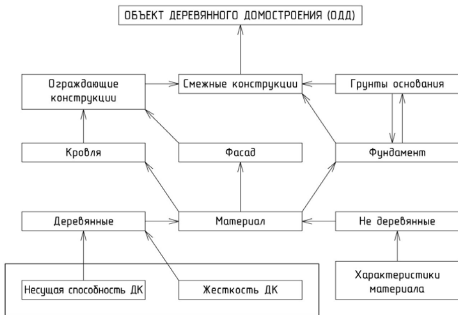
Рис. 6.5. Параметры технического состояния ДК по характеристикам и состоянию смежных конструкций
