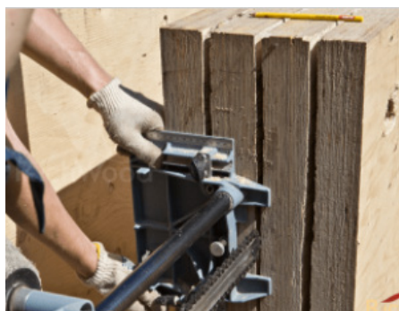
Фрезерование технологических пазов под соединительные металлические пластины «ДекТай®»
